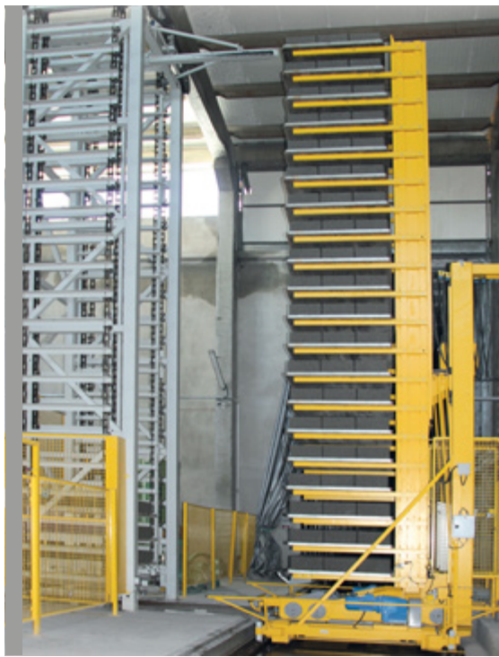
Chariot transbordeur avec transmission intégrale pour une vitesse de travail plus élevée.
