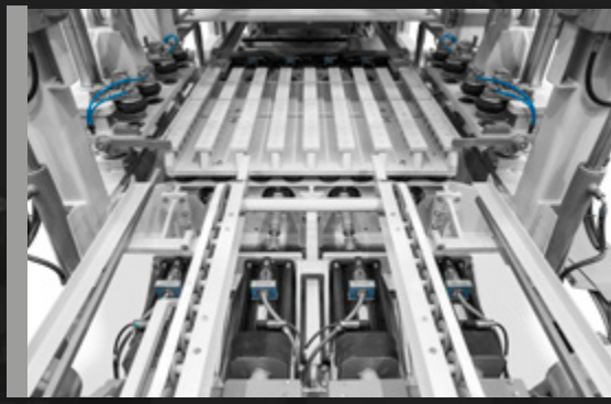
2 tables vibrantes indépendantes de série pour une meilleure compensation du remplissage. Lubrification continue par bain d'huile pour une maintenance minimale.
